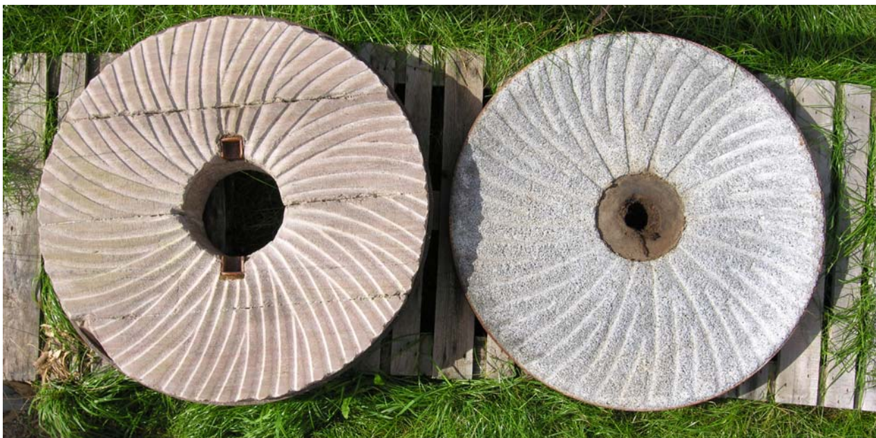
Tejn møllen kværnsten. Til højre liggeren af kunststen, - til venstre løberen af Nexø sandsten, sammensat af fire stykker, sammenspændt af to jernringe – det har kunststenen også
